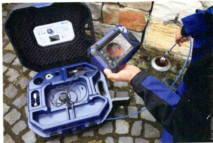
Das gesamte Kamerasystem ist in einen Koffer integriert. Beispielsweise kann die Haspel mit der Kamerastange und dem Kamerakopf aus dem Koffer genommen und abgespritzt werden.
